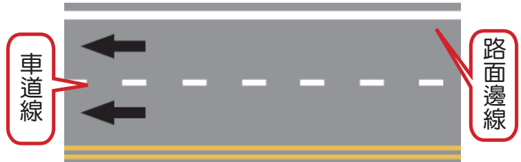
車道線及路面邊線
