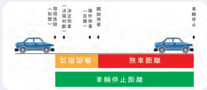
▲車輛停止距離 = 反應距離 + 煞車距離。
