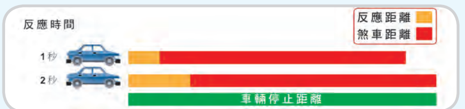
▲車速相同時，反應時間越長，所需車輛停止距離越長。
