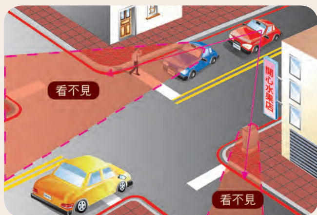
▲ 交岔路口、轉彎處、路邊停放車輛、招牌等容易造成靜體死角。
