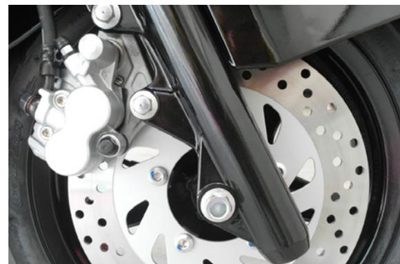
▲ 碟式煞車示意圖。
