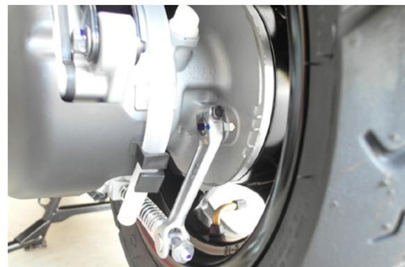
▲ 鼓式煞車示意圖。
